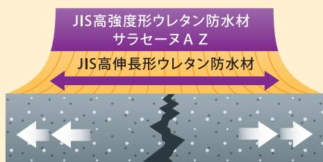
▶ 下地ひび割れ幅が50mmでも破断しない
